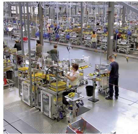
Linia produkcyjna gazowych kotłów wiszących
