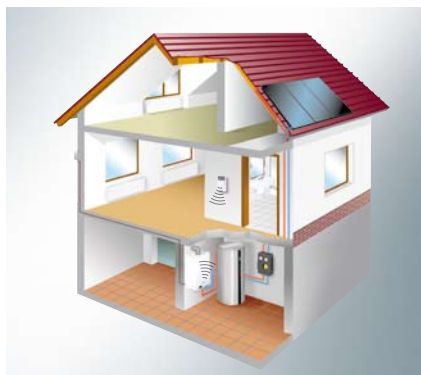
W celu połączenia kotła z regulatorem nie ma konieczności stosowania przewodów elektrycznych
