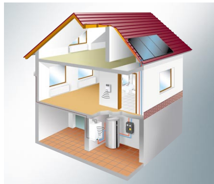
W celu połączenia kotła z regulatorem nie ma konieczności stosowania przewodów elektrycznych
