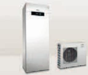
Nya modeller med splitutförande. Ingen risk för att kylvätskylaren frysar. Låg ljudnivå och enkla att installera med mark eller väggstativ. Provsäkra och effektiva COP 3,5 (A2iW95). Mycket bra värden på delast. Framledningstemperatur upp till 56 °C vid minus 15 °C.
